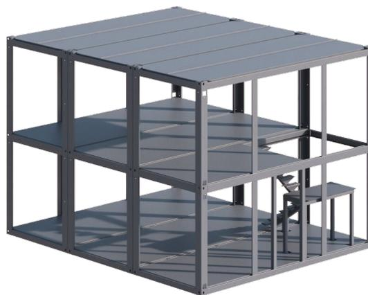
Блок-модули силового каркаса домокомплекта имеют по две рамы: раму основания, раму перекрытия и/или фальцевую раму покрытия; конструктив рамы — секционный; соединения конструктива рамы — сварные.
